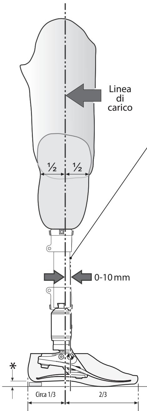
Allineare i dispositivi transfemorali in base alle istruzioni di montaggio fornite con il ginocchio. Mantenere la linea di carico entro i perni come illustrato, utilizzando se necessario i dispositivi di scorrimento e/o di inclinazione.
