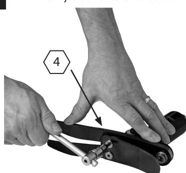
**4** Verwijder de teenveerschroef en vervang de teen. Gebruik bij het opnieuw in elkaar zetten Loctite 243 (926012) en zet vast met een moment van 35 Nm. Zorg ervoor dat de teenveer in het midden op de drager zit.
