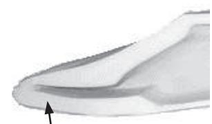
Position de la lame d'avant pied dans l'enveloppe.
