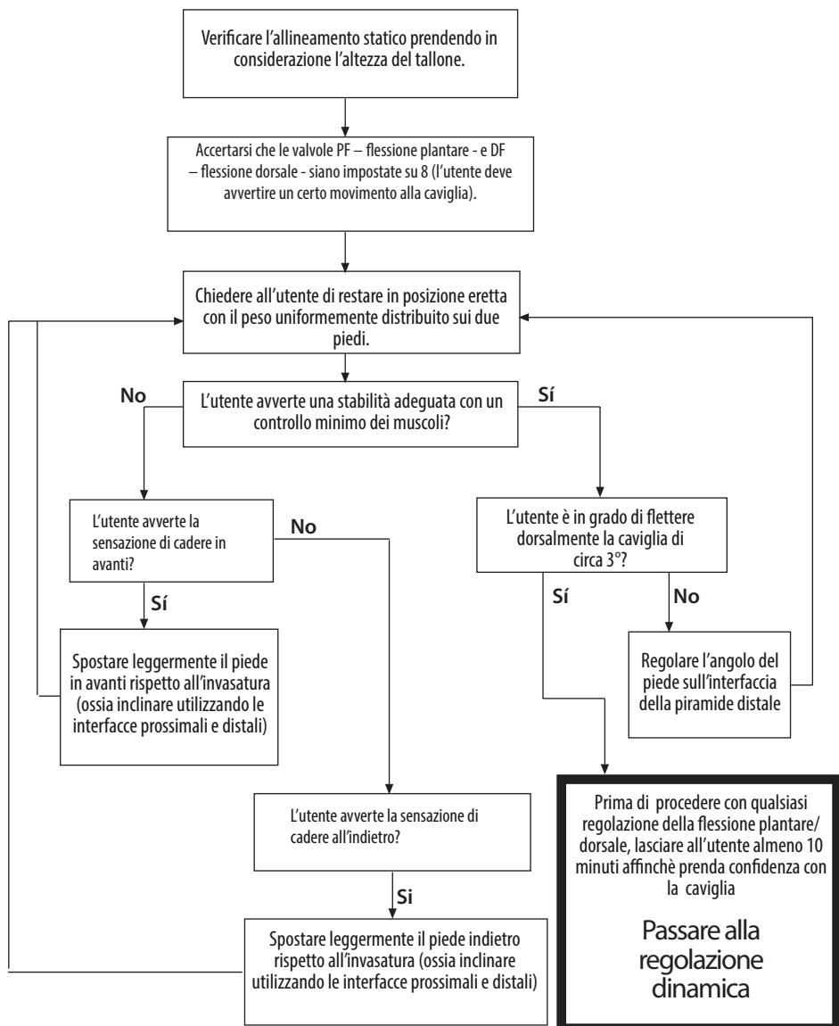
Utilizzare, se necessario, dispositivi di scorrimento e/o inclinazione per ottenere l'allineamento statico e la posizione eretta. Il dispositivo deve stimolare un certo grado di autoregolazione per ottenere il senso di equilibrio dell'utente in posizione eretta.
