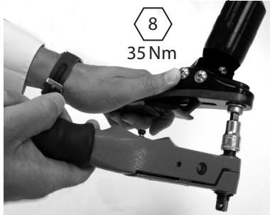
**5** Zet de eenheid weer in elkaar met de nieuwe hielveer. Gebruik Loctite 243 (926012) en zet het geheel vast met een moment van 15 Nm.
