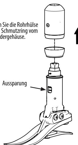
Reinigen und Fetten Sie die Lagerfläche neu.
