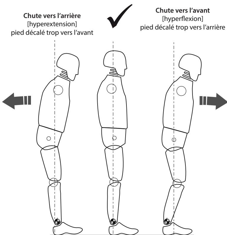
s'assurer que l'utilisateur est détendu et ne repose pas sur la limite (butée) de flexion dorsale
