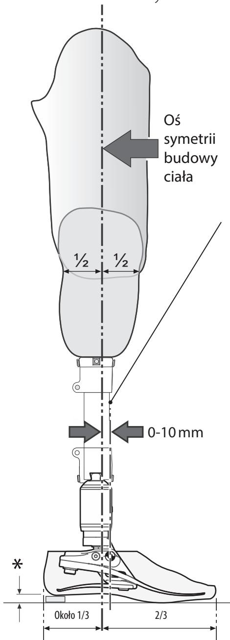
W przypadku wyrobów stosowanych u osób po amputacji na poziomie uda osiowanie należy przeprowadzać zgodnie z instrukcjami dołączonymi do przegubu kolanowego.
