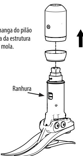
Limpe e volte a lubrificar a superfície do rolamento.
