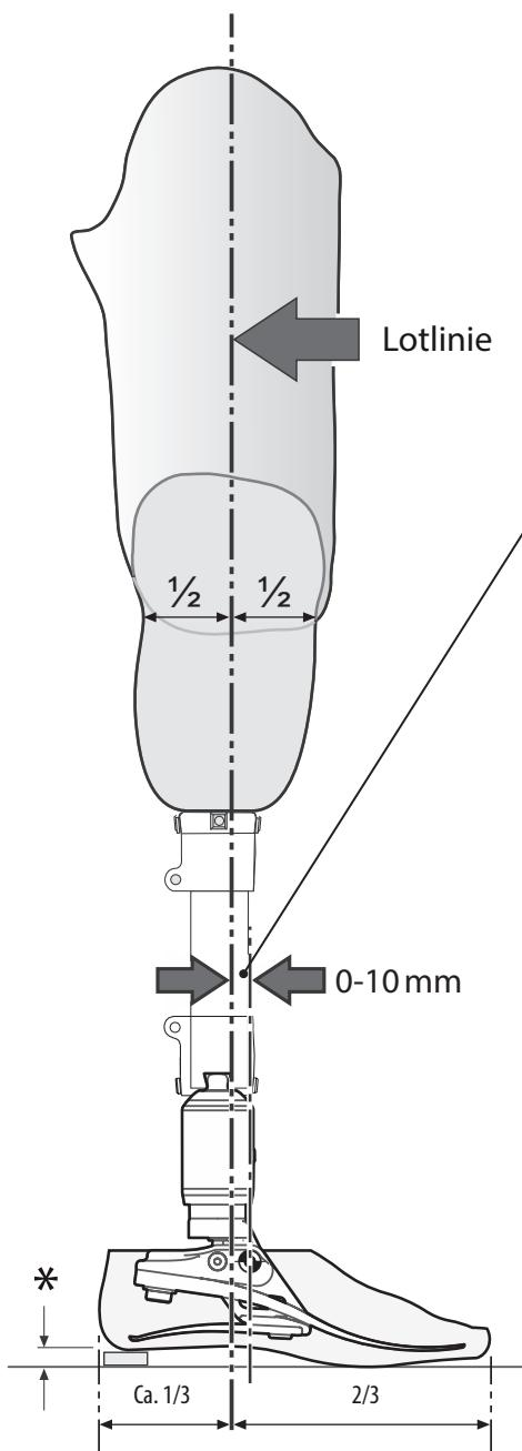
Beachten Sie bei der transfemoralen Anpassung die entsprechende Aufbaurichtlinie gem. der Gebrauchsanweisung des Prothesenkniegelenkes. Achten Sie darauf, dass die Lotlinie, wie in der Abbildung dargestellt, zwischen den Pfeilen verläuft. Nach Bedarf kippen oder verschieben Sie die entsprechenden Bauteile.
