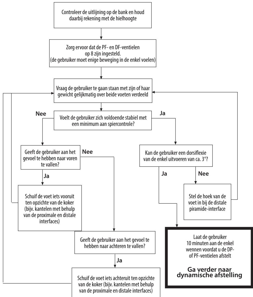
Gebruik verschuiving voor statische uitlijning en staan.
