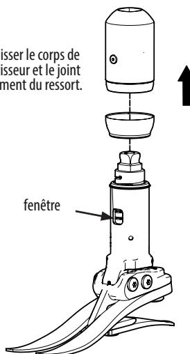
Nettoyer et lubrifier les surfaces coulissantes. Utiliser Sapphire Endure (928015) ou une graisse PTFE équivalente
