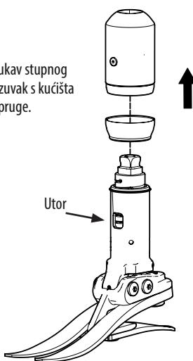
Očistite i ponovno podmažite nosivu površinu.
