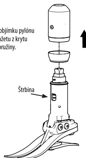
Vyčistite a znova namažte povrch ložiska.
