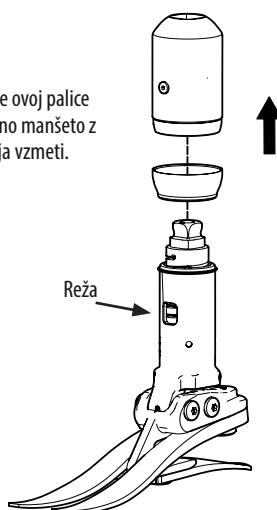
Očistite in znova namažite površino ležaja.
