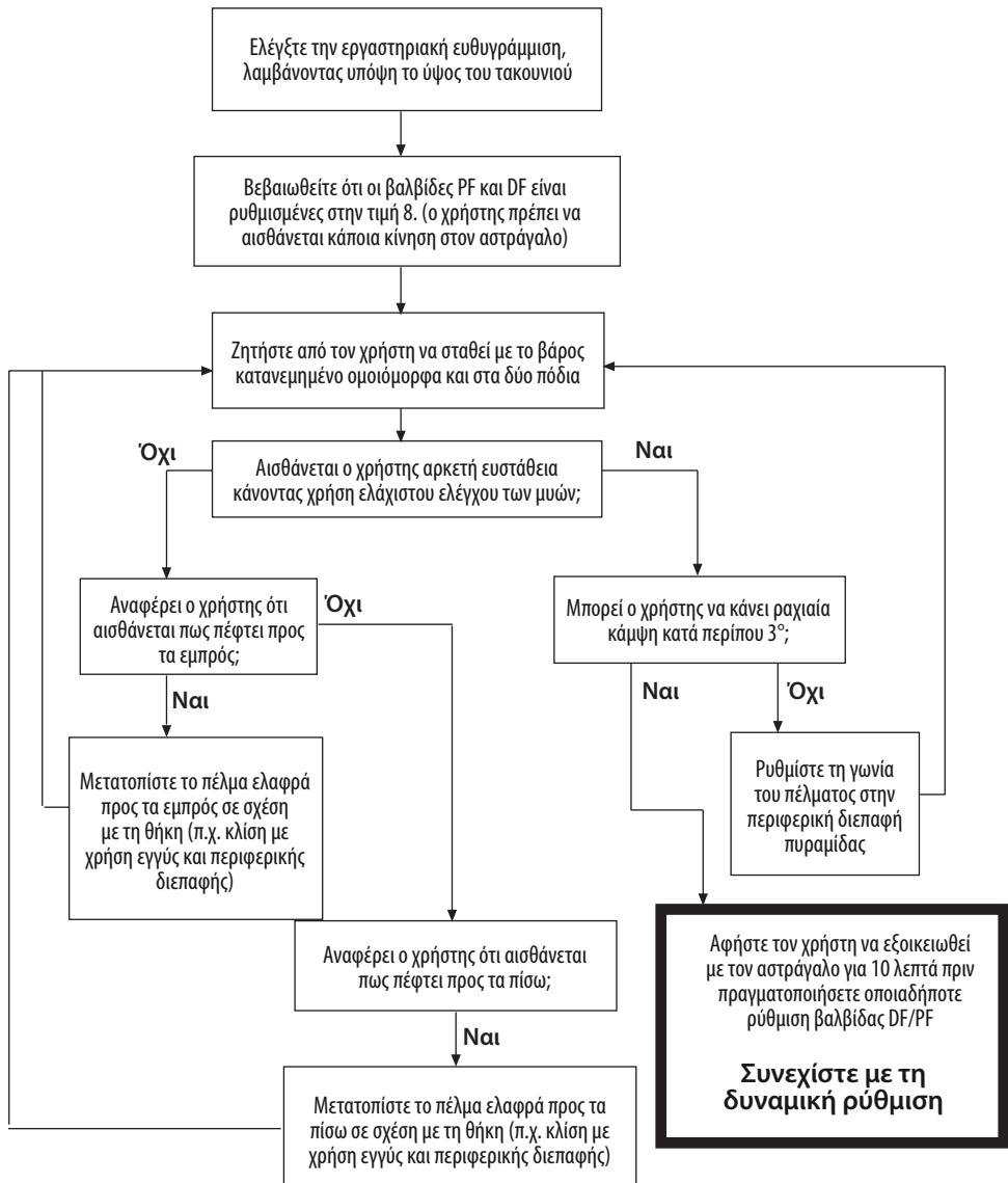
Χρησιμοποιήστε τη μετατόπιση για στατική ευθυγράμμιση και όρθια στάση.
