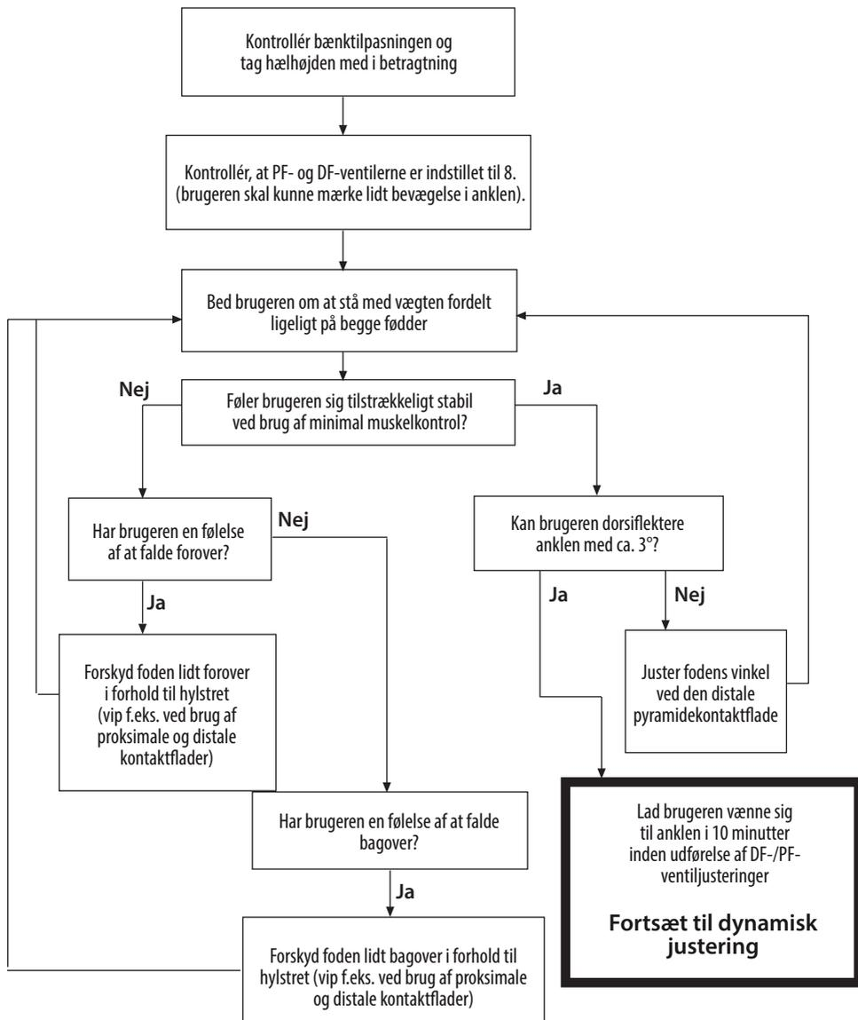
Brug forskydning til statisk tilpasning og stående stilling.
