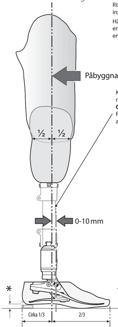
Kapa skenbensdelen till ungefärlig längd, men lämna kvar 10–15 mm för slutlig trimning.
