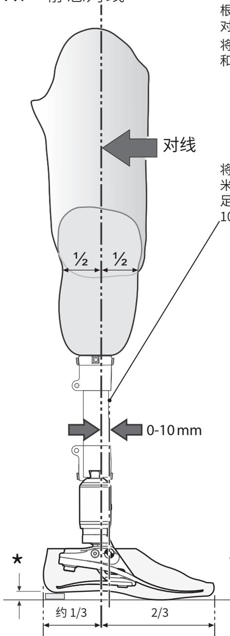
将义肢连接管切割至近似长度，留出 10-15 毫米用于最后裁修。**注意：**试验长度通常包含满足足跟、趾骨和轴向弹簧的轴向压缩所需的 10 毫米长度。
